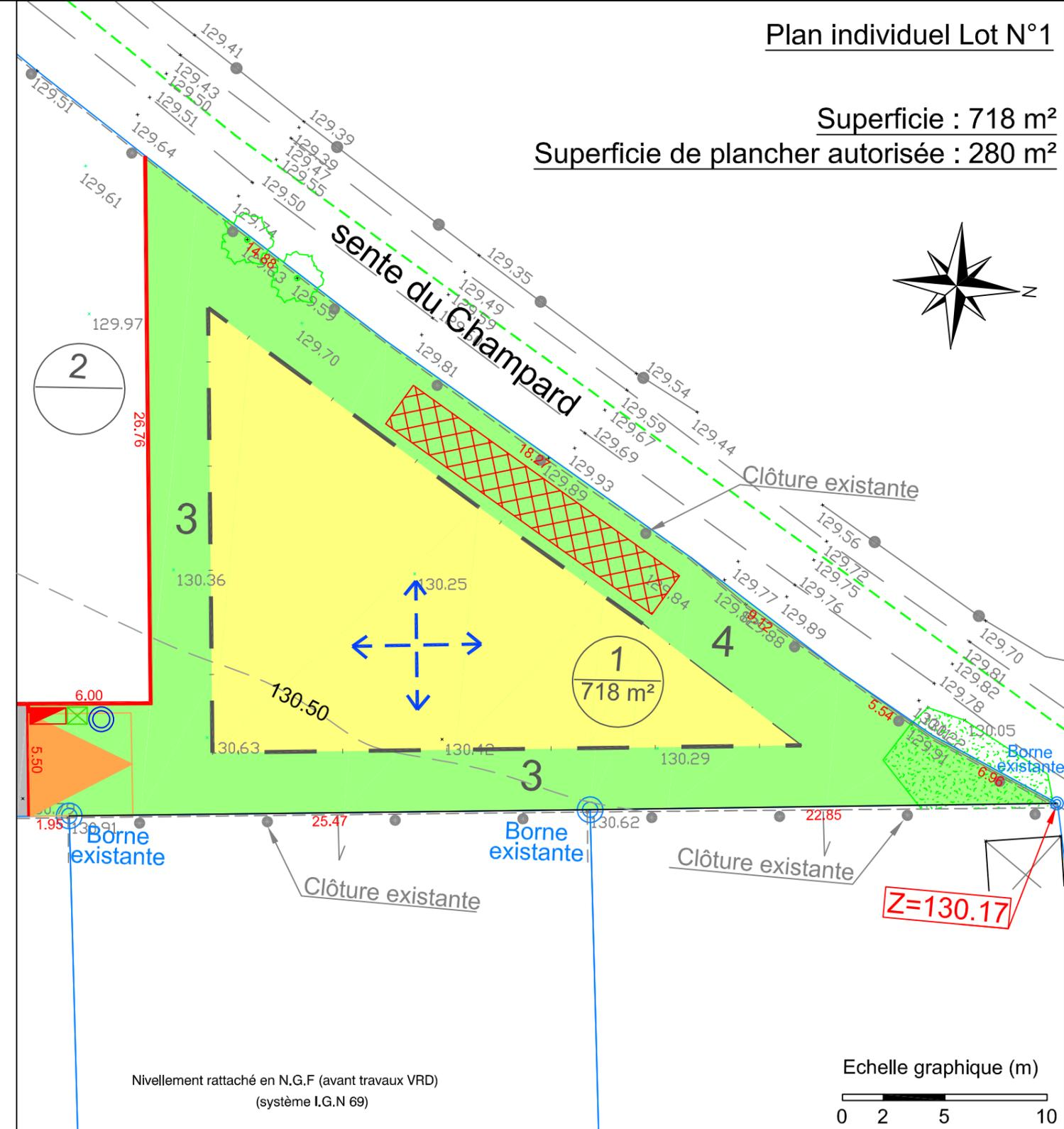
Nivellement rattaché en N.G.F (avant travaux VRD)
